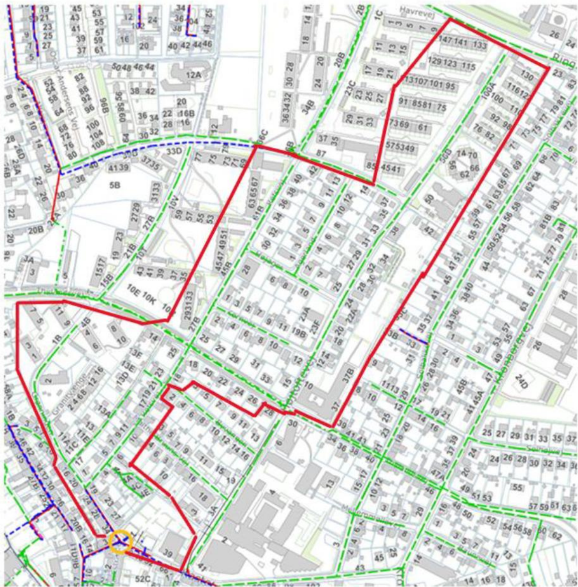
Figur 1 Ledningsregistrering af opland fra Thy Forsyning. Rød markering angiver oplandet, og gul cirkel marker placering af nødoverløb.
